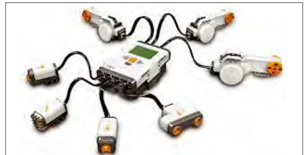
Εικόνα 1: Το σύστημα NXT με συνδεδεμένους αισθητήρες ( http://mindstorms.lego.com/ ).
